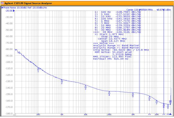
Figure 1. LVDS Output 120MHz 1.875MHz-20MHz 124fs
